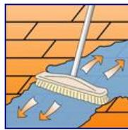
Auf vorgewässeter Fläche mit Schrubber verteilen und nach 5 Min. bürsten
